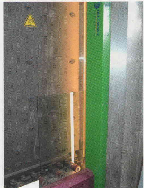
Mithilfe des Glassinspectors kann der Bediener selbst kleine Glaskratzer schnell und zuverlässig erkennen.
